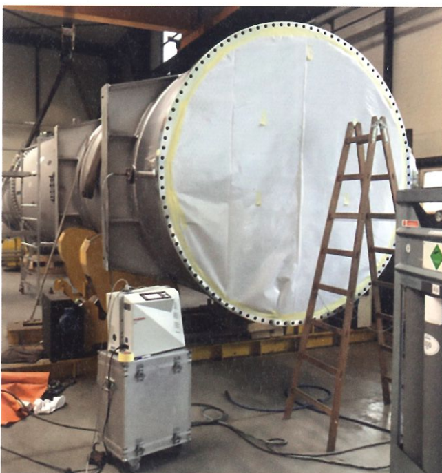
Bild 10: Prüfung eines großen Wärmetauschers
