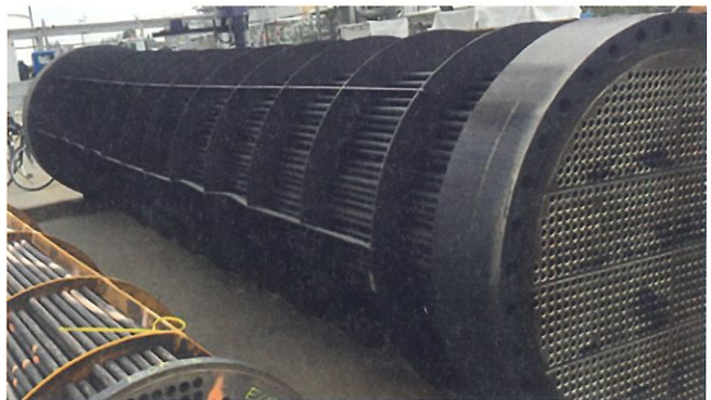
Bild 1: Beispiel Wärmetauscher – gezogenes Bündel – wiederkehrende Prüfung
