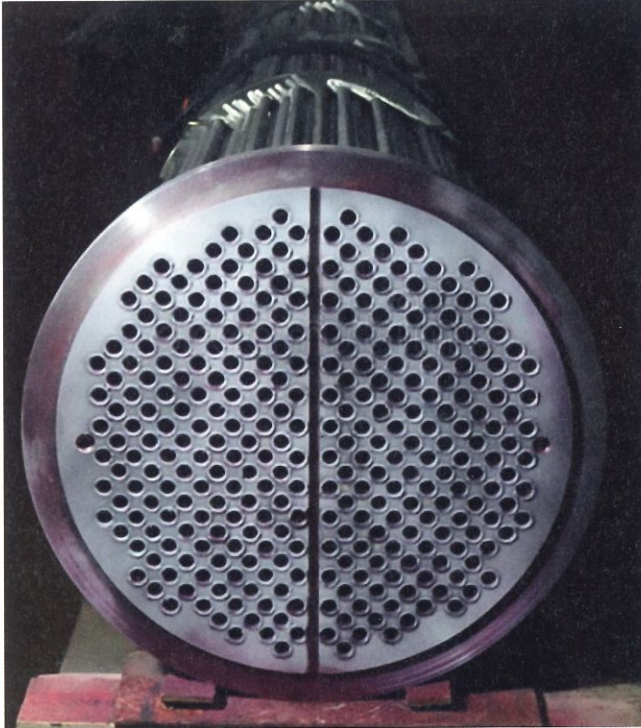
Bild 3: Beispiel Wärmetauscher – Anzeigenfreie PT Prüfung
